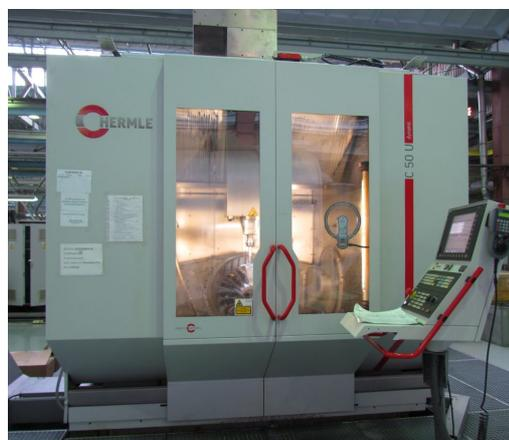
Рис. 12. Чистовая обработка моноколеса на 5-ти координатном станке HERMLE C50U
