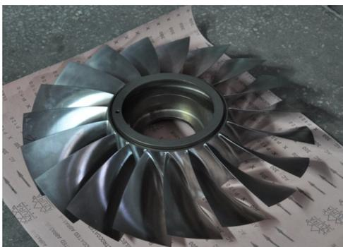
Рис. 1. Колесо вентилятора 1-й ступени
