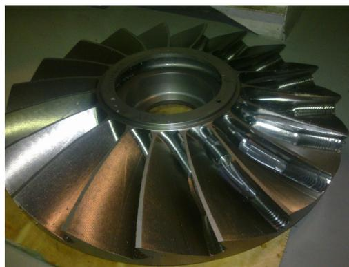
Рис. 6. Заготовка моноколеса после черновой обработки на станке ИС-800
