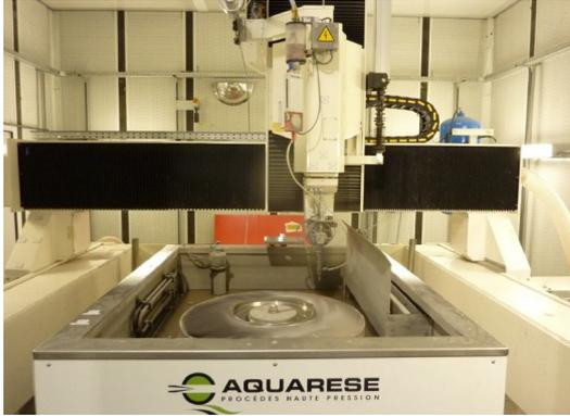
Рис. 7. Станок гидроабразивной резки EVODAN компании AQUARESE
