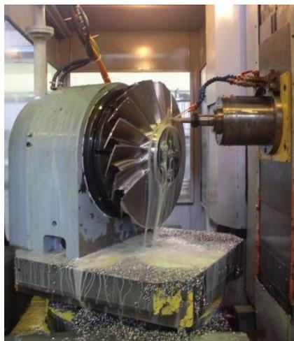
Рис. 5. Предварительная обработка межлопаточного пространства на станке с ЧПУ ИС-800 по схеме 3+2
