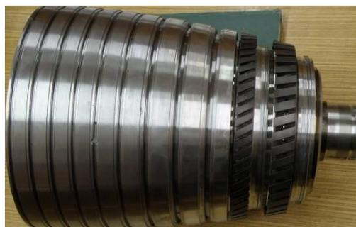
Рис. 1. Внешний вид барабана компрессора
