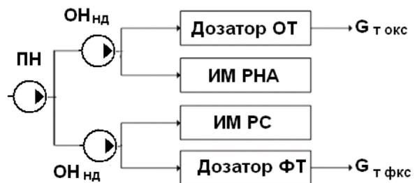
Рис. 3. Схема с двумя параллельными насосами (или двумя параллельными контурами)
