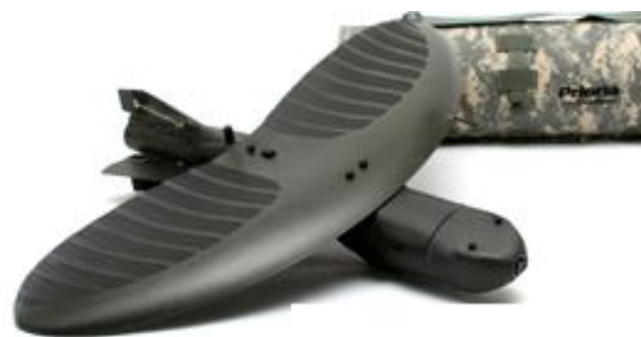
Рис. 5. БЛА «Maverick» с криволинейным крылом в плане
