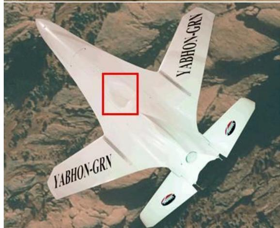
Рис. 4. БЛА ADCOM «Yabhoon-GRN» с верхним утопленным ВУ
