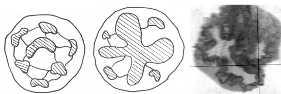
Рис. 1. Формообразование контура кромки входного сечения купола парашюта большой площади на подготовительном этапе
