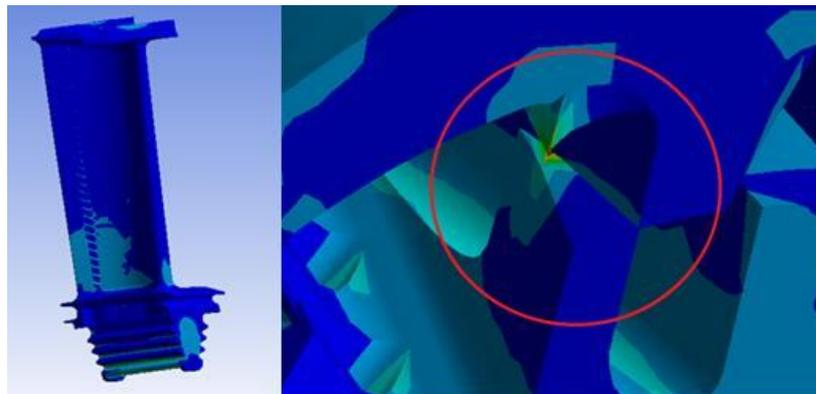
Рис. 4. Распределение эквивалентных напряжений на поверхности лопатки и в местах локализации
