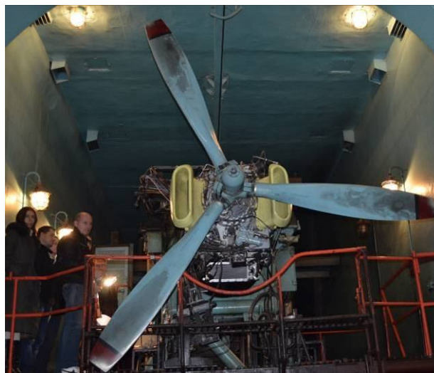
Рис. 3. Экспериментальный двигатель при проведении резонансных испытаний на стенде АО "Мотор Сич"
