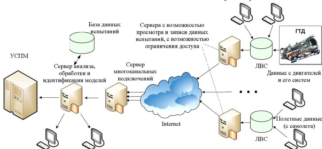
Рис. 8. Фрагмент схемы удаленного подключения к УСПМ
