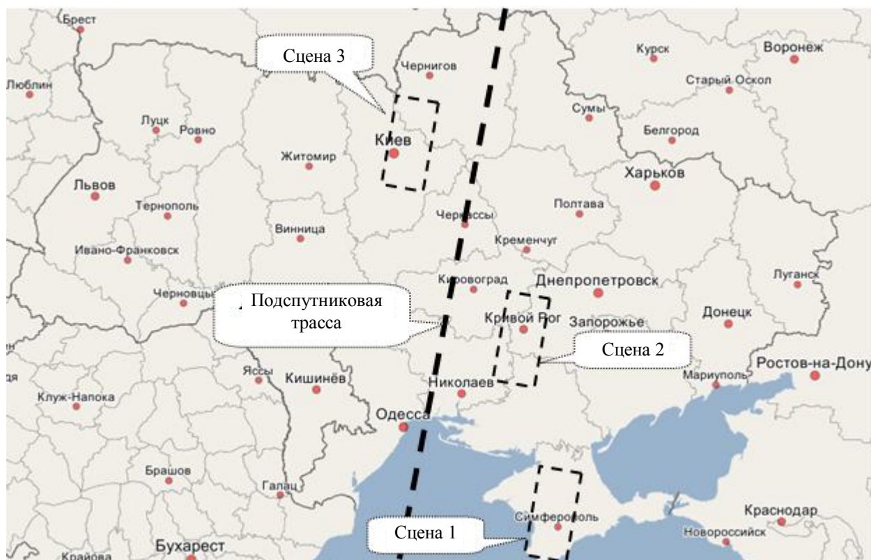
Рис. 4. Съемка с разных сторон от подспутниковой трассы
