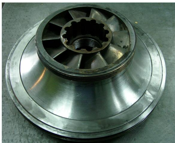
Рис. 7. Изготовленное рабочее колесо
