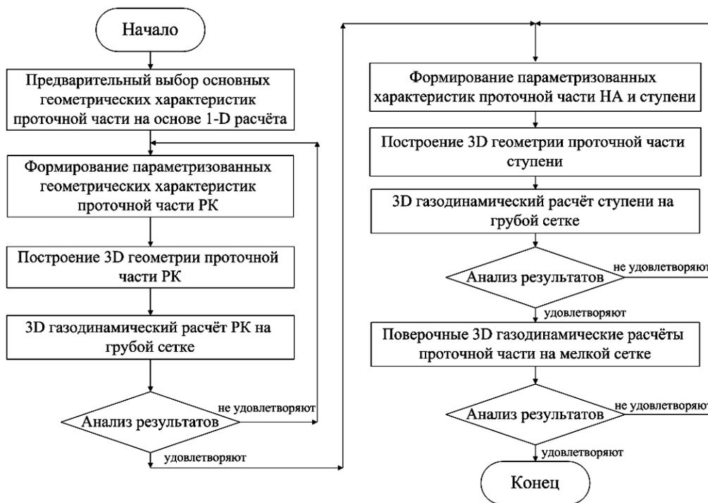
Рис. 1. Блок-схема алгоритма проектирования проточной части ступени
