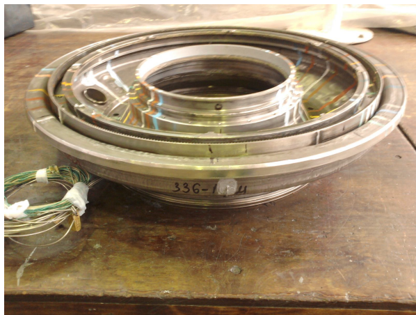
Рис. 3. Общий вид ЩУ после прохождения экспериментальных испытаний на изделии АИ-336-6,3
