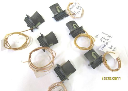
Рис. 4. Общий вид лопаток ТК с ВПТ
