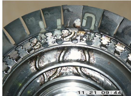
Рис. 5. Колесо турбины с пленочными тензорезисторами на лопатках
