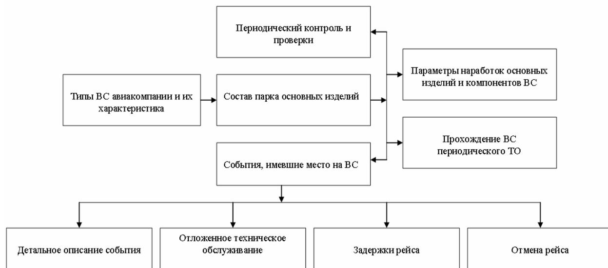
Рис. 3. Схема взаимодействия таблиц в базе данных системы контроля надежности на уровне авиакомпании (стрелкой обозначена связь таблиц мастер-таблица – подчиненная таблица)
