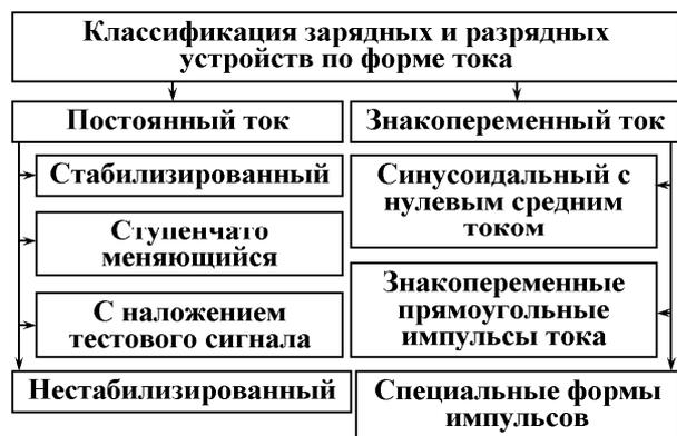
Рис. 7. Классификация существующих типов зарядных и разрядных устройств по форме тока
