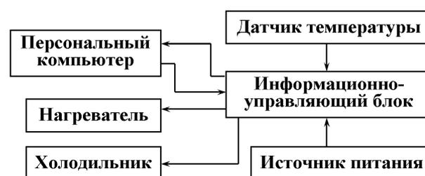
Рис. 11. Структурная схема реверсивного терморегулятора
