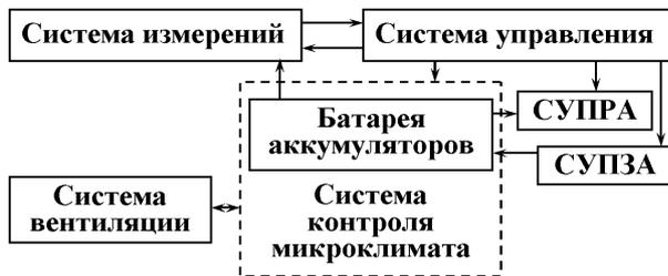
Рис. 3. Схема стенда для ресурсных испытаний электрохимических аккумуляторов
