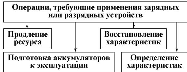
Рис. 4. Типичные операции с аккумуляторами, требующие применения специальных зарядных и разрядных устройств
