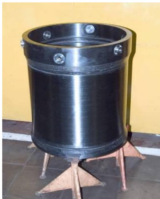
Рис. 6. Объектив КА из углепластика
