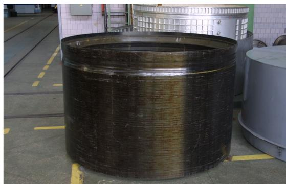
Рис. 2. Хвостовой отсек из углепластика
