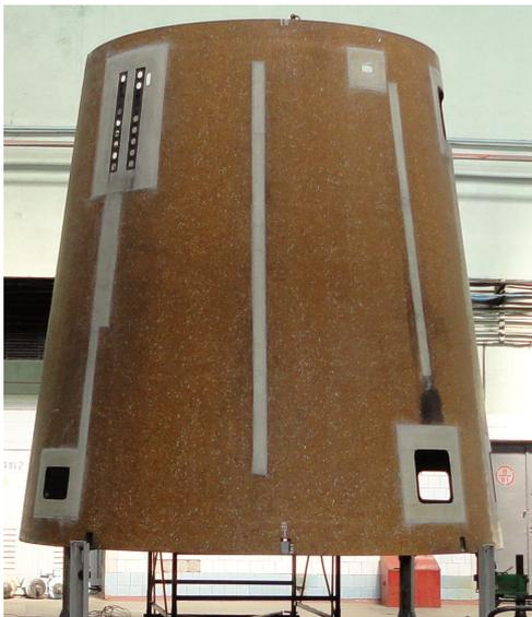
Рис. 3. Межступенчатый отсек из ПКМ
