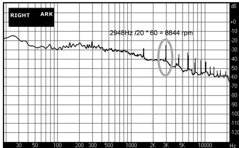
Рис. 1. Спектр звукового сигнала компрессора ГТН главного дизеля 6L80MCE
