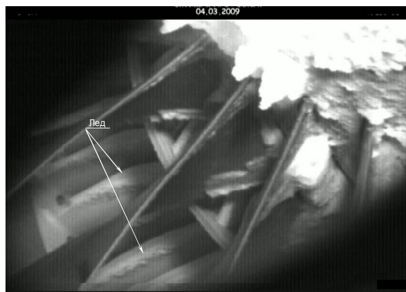
Рис. 1. Нарастание льда на спрямляющем аппарате вентилятора при испытаниях на обледенение (фото со стробоскопической видеокамеры)
