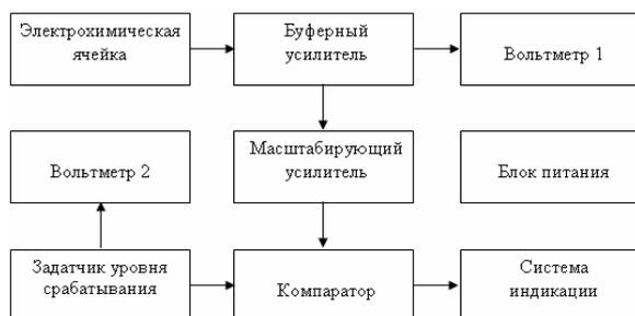
Рис. 4. Структурная схема прибора ЭЛПОТ
