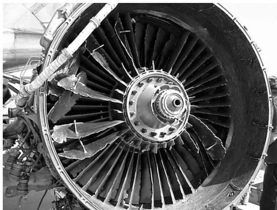
Рис. 1. Последствия попадания стаи птиц в двигатель
