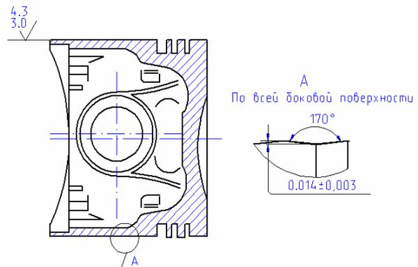
Рис. 2. Эскиз микрорельефа на наружной поверхности поршня
