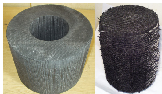
Рис. 9. Образец кольцевого (после обработки) и цилиндрического АК
