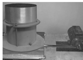
Рис. 7. Оборудование установки вертикальных стержней вибрацией
