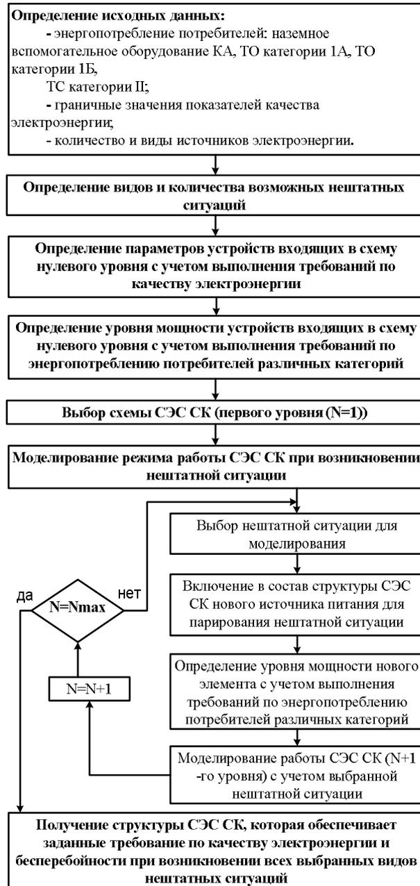
Рис. 2. Алгоритм процесса формирования структуры СЭС СК
