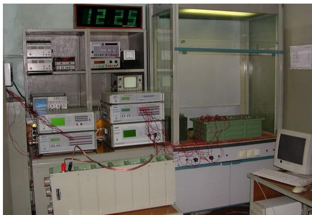
тий, состоящих из заряда АК импульсным реверсивным асимметричным током и глубокого разряда ступенчатым током;
