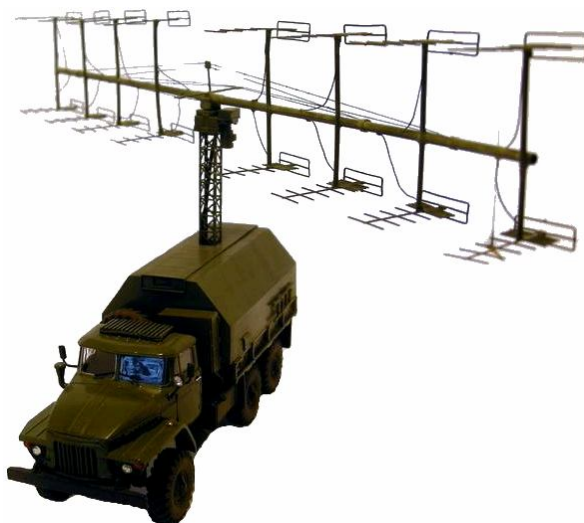
Рис. 1. Машина АЩП РЛС П-18
