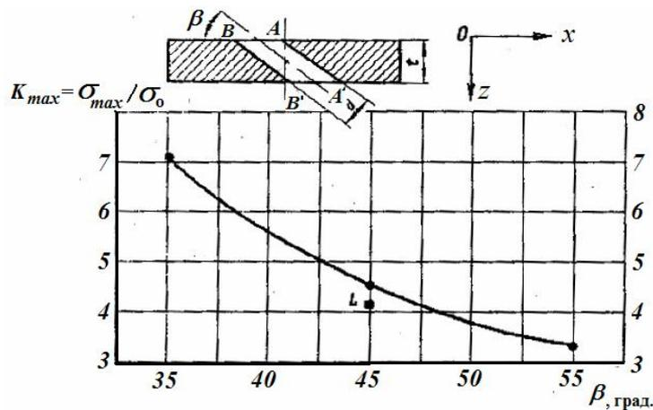
Рис. 4. Изменение максимальной величины коэффициента концентрации напряжений  $K_{\sigma}$  в зависимости от угла наклона  $\beta$  оси отверстия к плоскости пластины [2]
