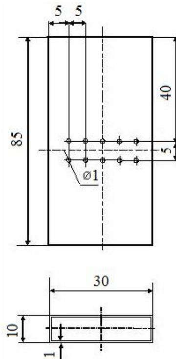
Рис. 1. Схема образца
