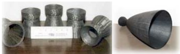
Рис. 1. Сопловые вставки с плетеной структурой АК
