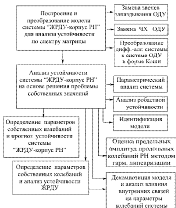
Рис. 1. Схема выполнения анализа устойчивости динамической системы “ЖРДУ – корпус РН” на основе решения проблемы собственных значений
