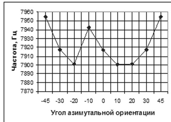
Рис. 5. Изменение шестой собственной частоты в зависимости от изменения угла азимутальной ориентации. Преимущественно изгибно-крутильные колебания
