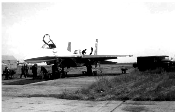
Рис. 8. Самолет Су-27 на динамометрическом стенде тяги
