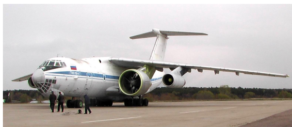
Рис. 4. Летаящая лаборатория Ил-76ЛЛ с двигателем НК-93
