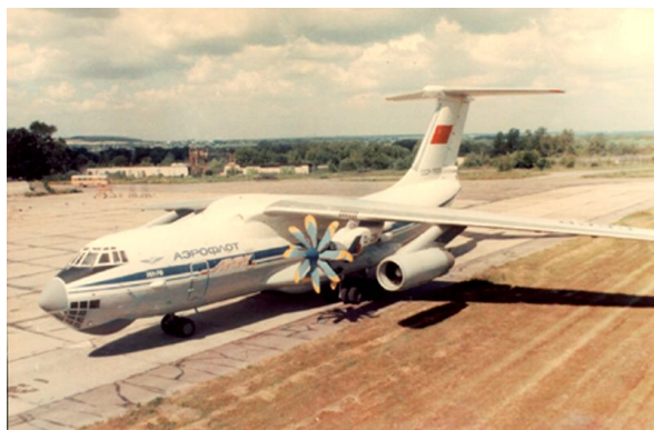
Рис. 3. Летаящая лаборатория Ил-76ЛЛ с двигателем Д-27
