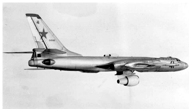
Рис. 1. Летающая лаборатория Ту-16 с двигателем Д-36
