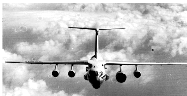
Рис. 2. Летающая лаборатория Ил-76 с двигателем Д-18Т
