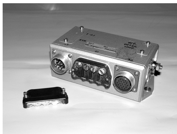
Рис. 1. Блок регулирования температуры БРТ разработки ОАО «Элемент»
