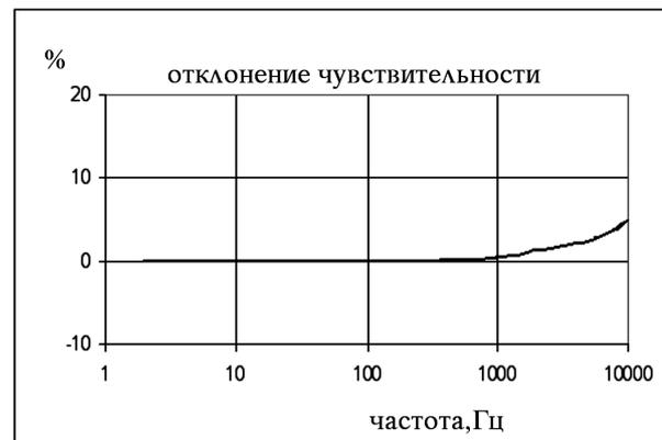
Рис. 1. Температурная и частотная характеристика датчика СР103
