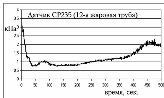
Рис. 5. СКЗ пульсаций давления газа в КС
