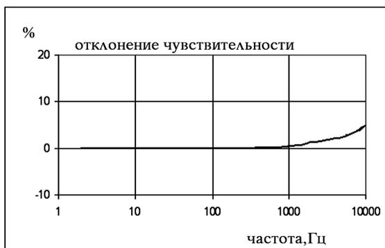
Рис. 2. Температурная и частотная характеристика датчика СР235
