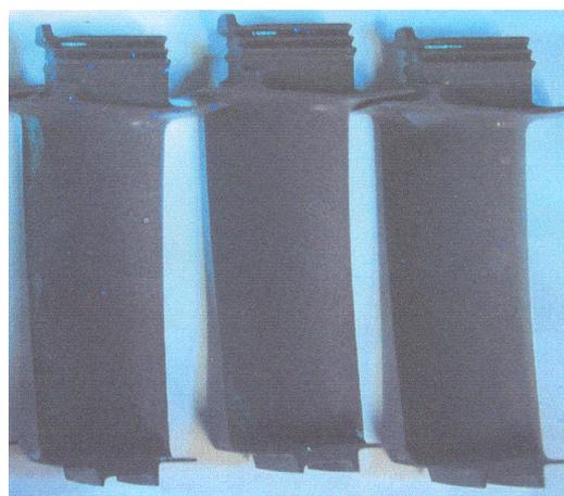
Рис. 2. Трещина в сечении III-III хвостовика рабочей лопатки турбины
