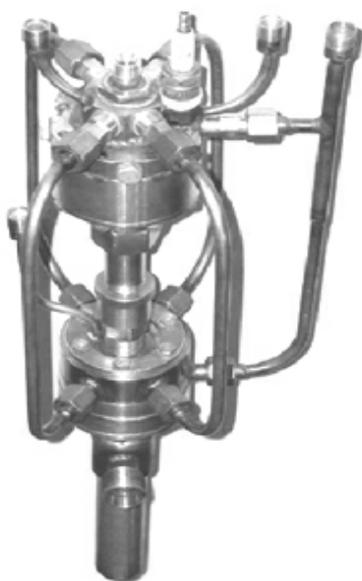
Рис. 1. Внешний вид двухкамерной горелки для ВВТН «Град-В»
