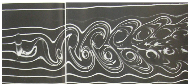
Рис. 3. Вихревая дорожка Кармана за круговым цилиндром [8]
