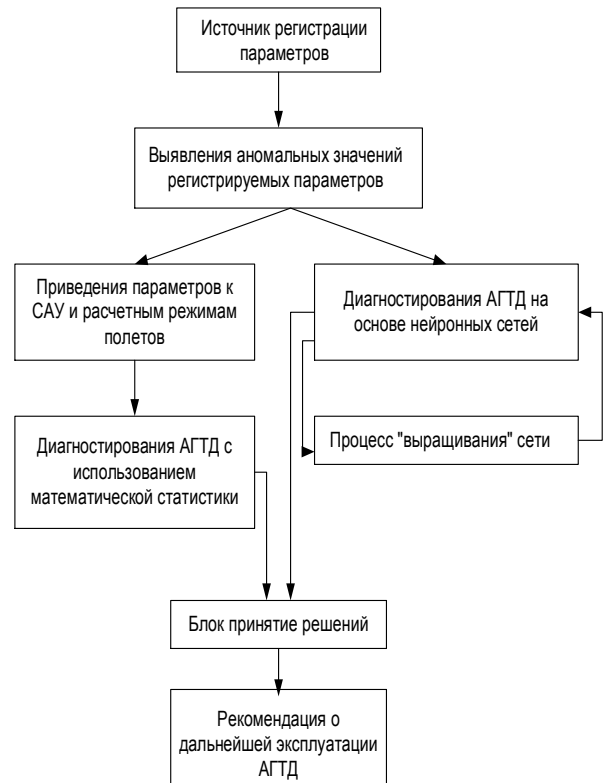
Рис. 1. Обобщенная схема комплексной системы диагностирования АГТД
