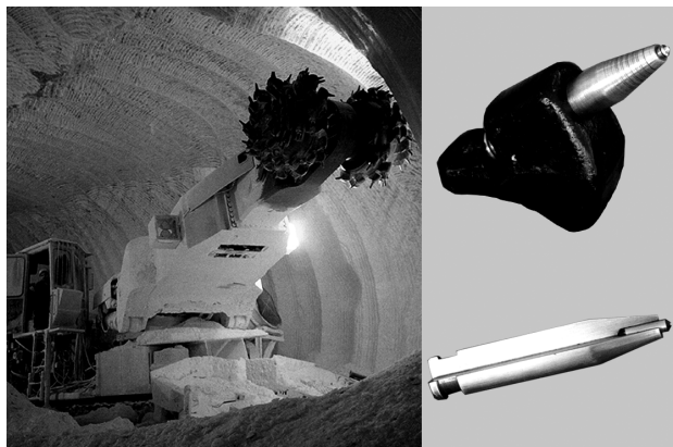
Рис. 6. Горнопроходческий комбайн; резец
