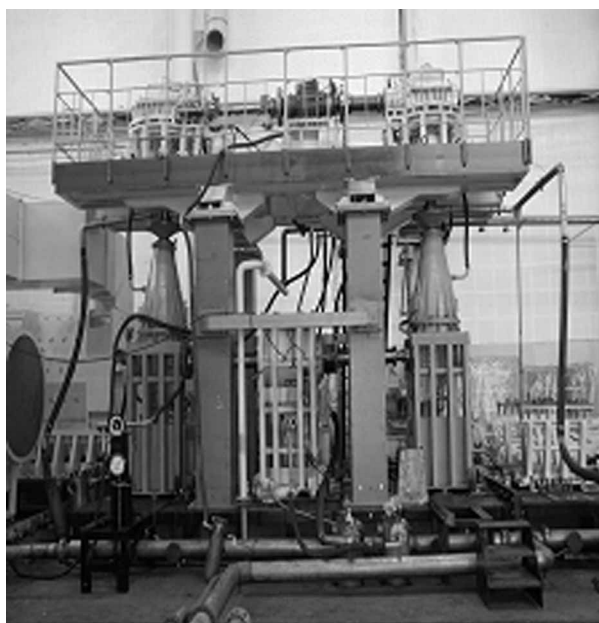
Рис. 4. Универсальный стенд для испытаний угловых редукторов
