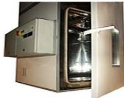
Рис. 4. Камера тепла и влажности
