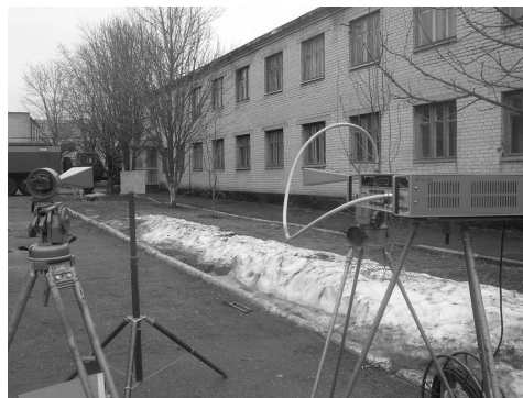
Рис. 4. Внешний вид установки для измерения мощности отраженного сигнала на частоте 37,5 ГГц
