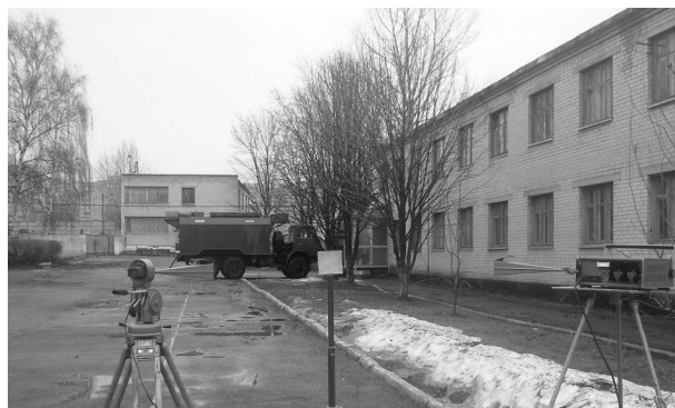
Рис. 3. Внешний вид установки для измерения мощности отраженного сигнала на частоте 10 ГГц
