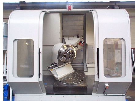
Рис. 11. Общий вид 5-ти координатного станка фирмы «LIECHT» TURBOBLISK 1500
