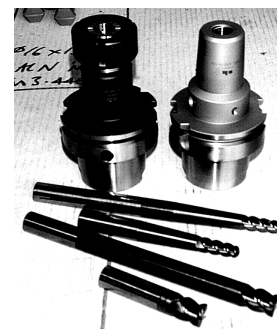
Рис. 17. Инструмент и гидрооправки фирмы SANDVIK
