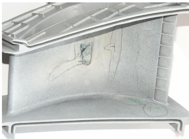
Рис. 1. Внешний вид поврежденной лопатки
