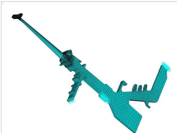
Рис. 1. Конечноэлементная модель сектора рабочего колеса
