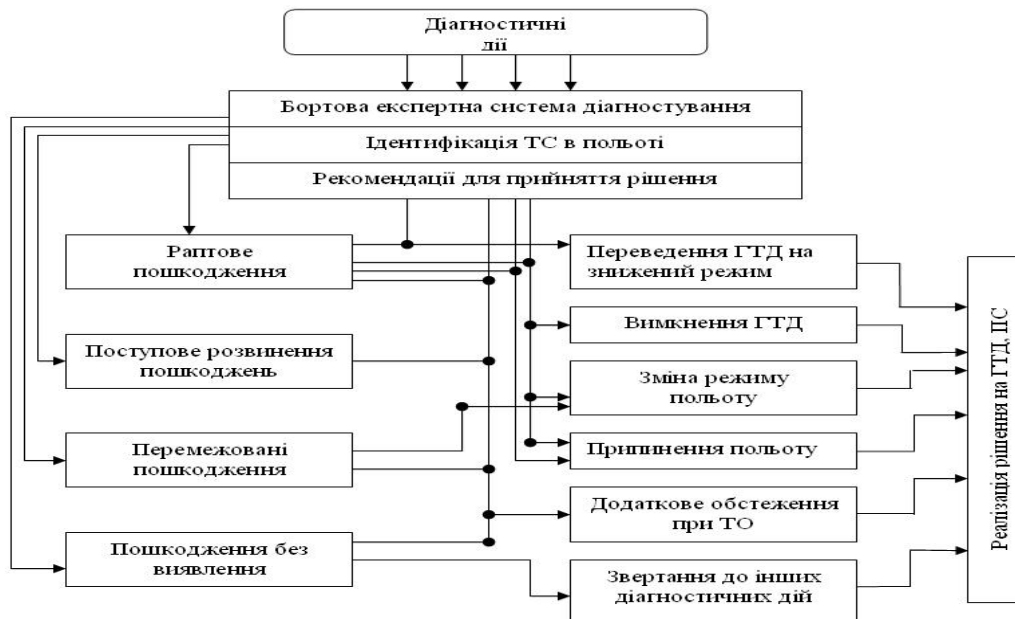
Рис. 2. Схема використання ЕС діагностування в процесі льотно-технічної експлуатації ГТД (І етап діагностування ГТД)
