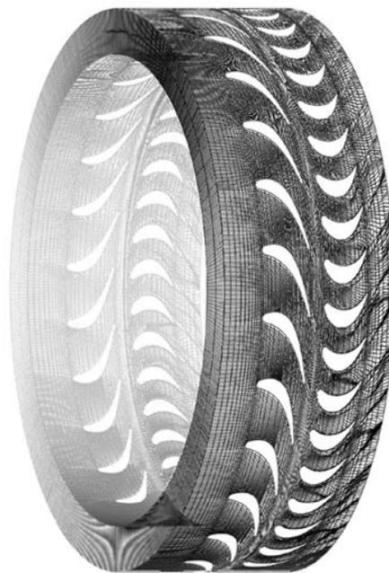
Рис. 2. Расчетная область и конечно-разностная сетка
