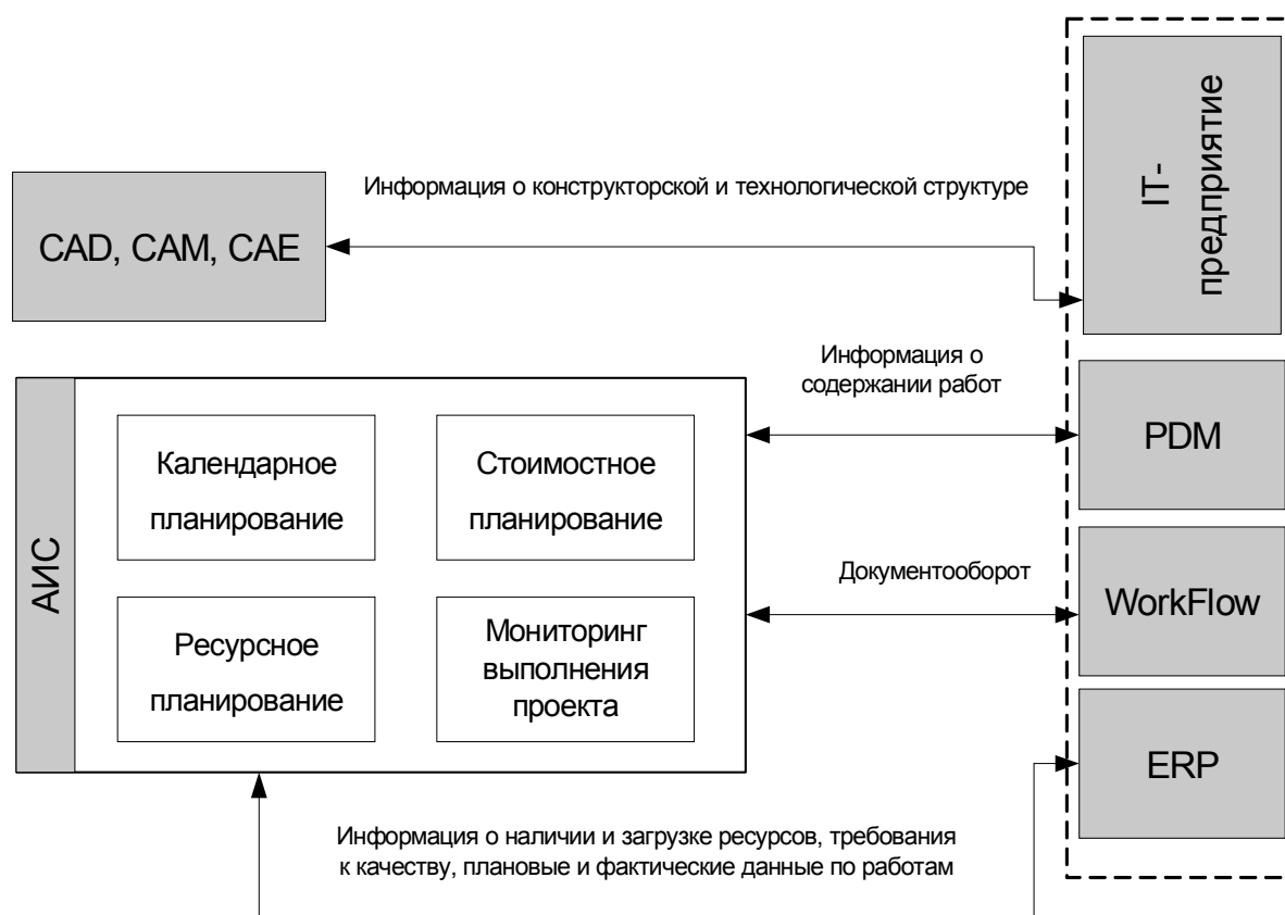
Рис. 2. Схема информационных потоков между АИС УП и КИС
