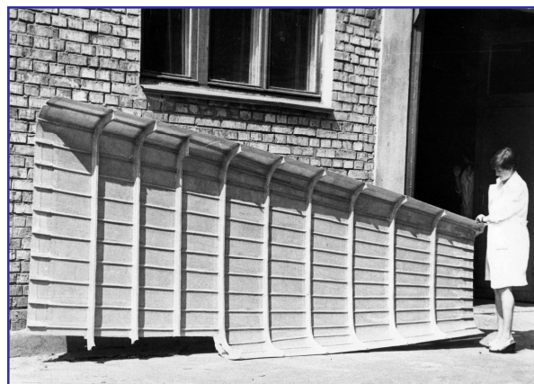
Рис. 15. Панель низа фюзеляжа самолета Ан-2 для замены на серийных машинах (1980 г.)
