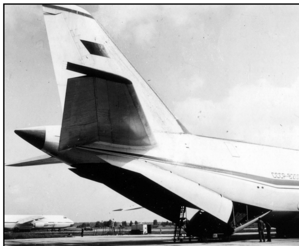
Рис. 11. Створки грузолука самолета Ан-124 (1981 г.)
