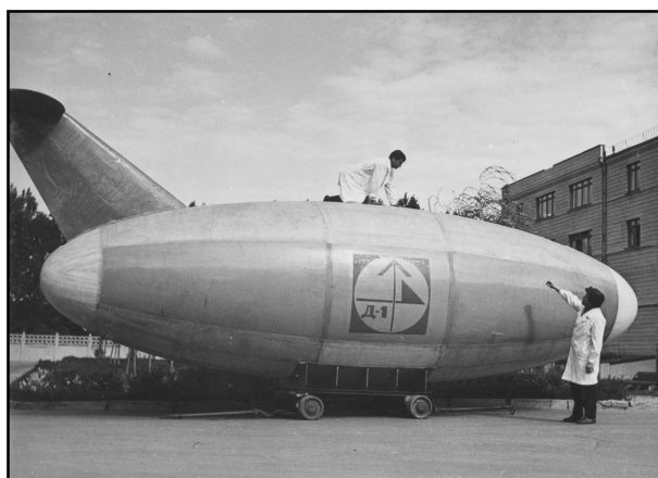
Рис. 13. Жесткий корпус экспериментальной модели дирижабля
