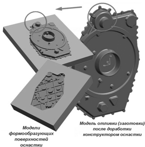
Рис. 6. Автоматическое отображение изменений в модели отливки и формообразующих поверхностях
