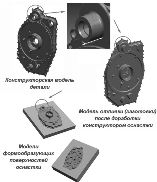
Рис. 1. Пример сквозного проектирования от модели детали до получения формообразующих поверхностей
