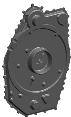
Рис. 3. Модель отливки (заготовки) после доработки конструктором оснастки
