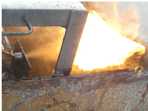
Рис. 8. Сжигание ИКЖТ с помощью форсунки
