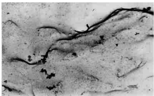
Рис. 1. Микрофрактограмма усталостного излома образца с детонационным напылением – 4000х
