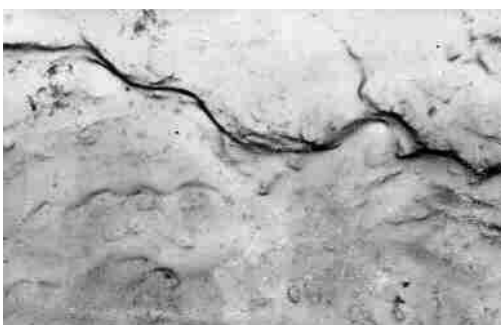
Рис. 1. Микрофрактограмма усталостного излома образца с детонационным напылением – 4000х
